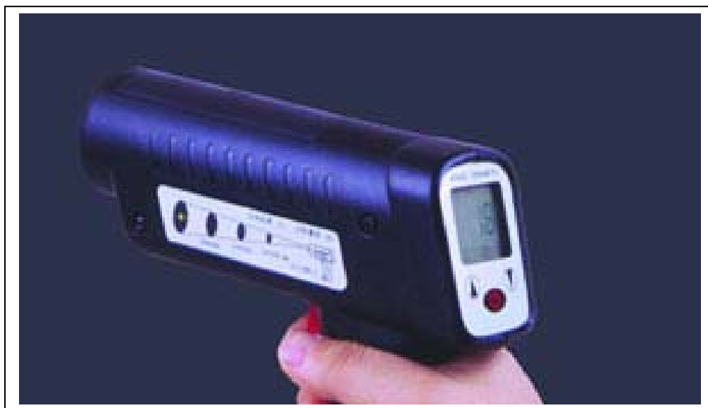
Hình 12. Nhiệt kế không tiếp xúc hay nhiệt kế hồng ngoại (Nitonuk Ltd. 2003)
